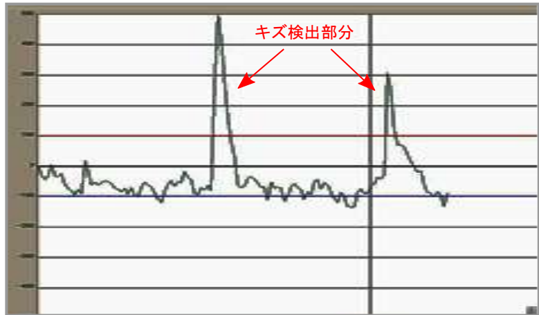
素材 SUS材 φ7.5mm 移動速度 30m/min
